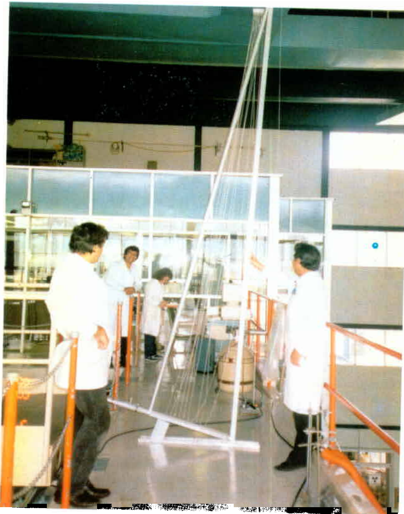
Instrumentos perfeccionados se utilizan para medir el quemado de los elementos combustibles de un reactor de investigación en México.
