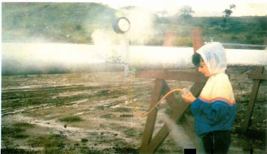
Toma de muestras de gases geotérmicos de un pozo en el campo geotérmico del Volcán Miravalles en Costa Rica. (Foto: Vaca/San José)
