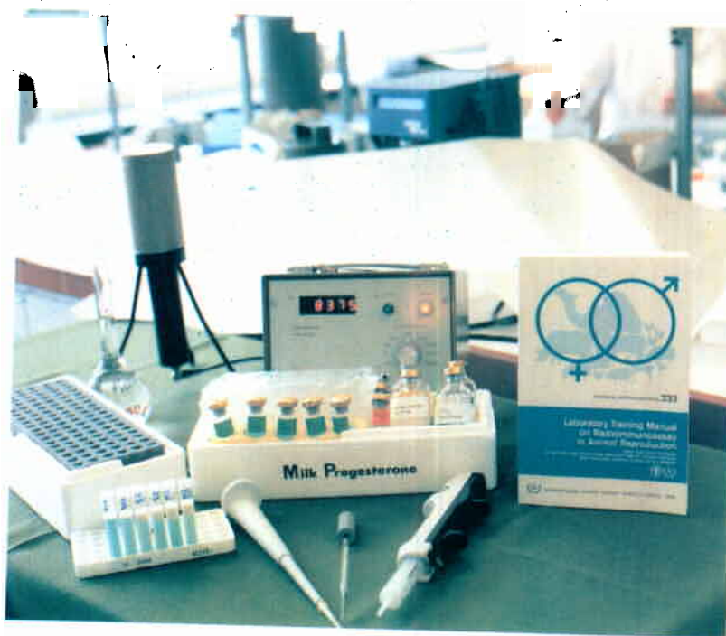
Un laboratorio de RIA completo —un juego FAO/OIEA para la medición de progesterona en la leche, un contador gamma de pozo único, un bastidor de decantación y pipetas.
